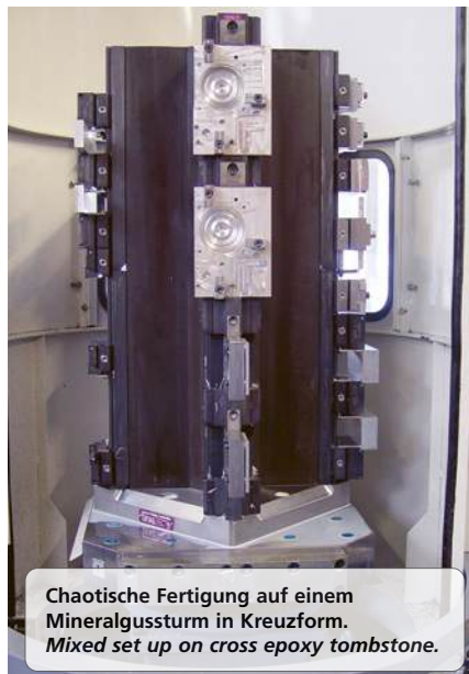
Mineralgussturm kombiniert bestückt mit Power Clamp und Magneten. Epoxy cube equipped with magnet and Power Clamp
