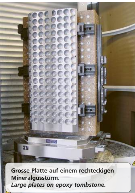
Mineralgussturm kombiniert bestückt mit Power Clamp und Magneten. Epoxy cube equipped with magnet and Power Clamp
