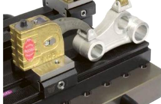
**NS** = Trägermodul freie Positionierung ohne Verzahnung
