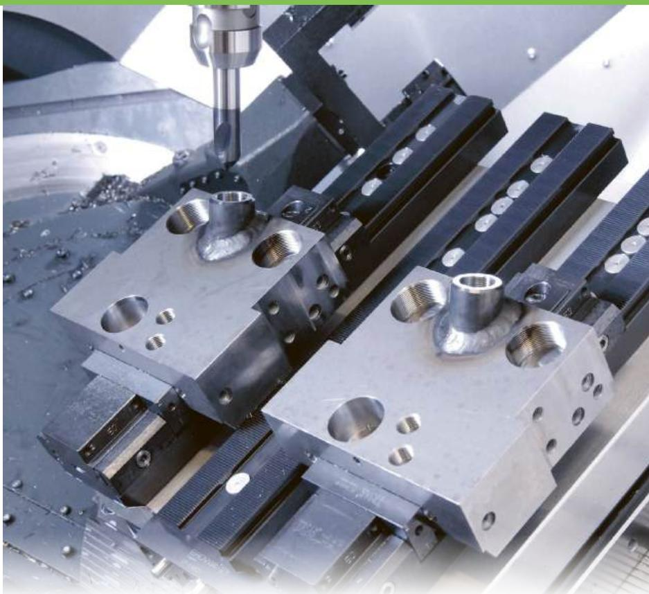
**Die Basisschiene ist die Grundlage des Power Clamp Spannsystems**
