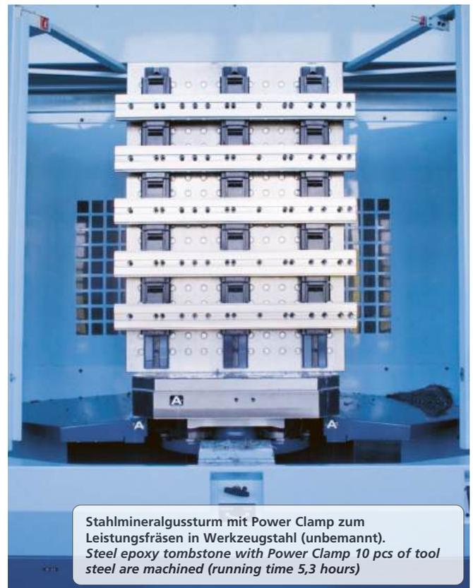
Stahlmineralgussturm mit Power Clamp zum Leistungsfräsen in Werkzeugstahl (unbemannt).
