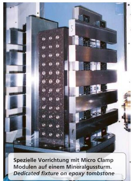
Spezielle Vorrichtung mit Micro Clamp
