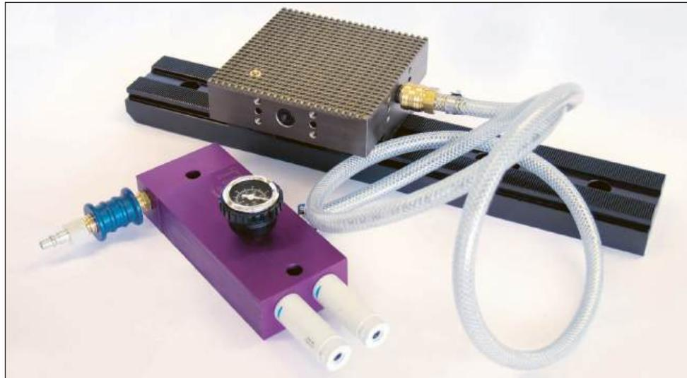
Bei der Spannung mit Vakuum wird der Druck nicht mechanisch auf das Werkstück sondern durch die umgebende Atmosphäre ausgeübt. Dadurch werden die Werkstücke schonend und gleichmässig über die ganze Auflagefläche fixiert, so dass kaum Vibrationen entstehen.
