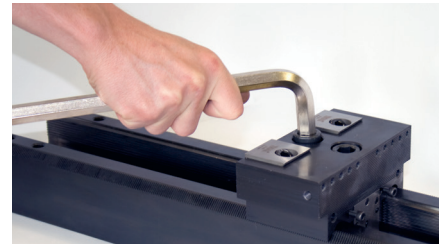
3. zwei Schrauben anziehen fasten two screws
